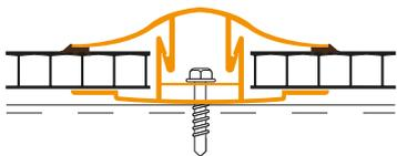
El Perfil **GCP** Policarbonato está PATENTADO por Plazit-Polygal. Este perfil está compuesto por una base y una tapa con gasket Termoplástico Elastomérico fusionado en co-extrusión, diseñado para espesores de plancha 6, 8, 10 mm. Dado el sello en los bordes, este perfil se recomienda para usarlo en pendientes mayores a 5% el gasket puede ser gris o negro.
